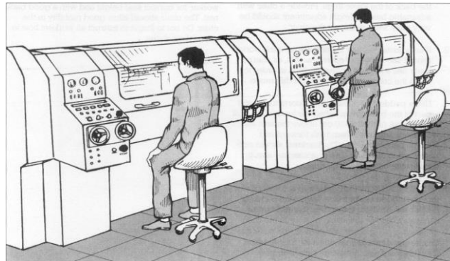
Şekil 6.7. Ayakta çalışılan yerlerde sandalyelere oturarak çalışmak dikkatli çalışması için daha uygundur.
