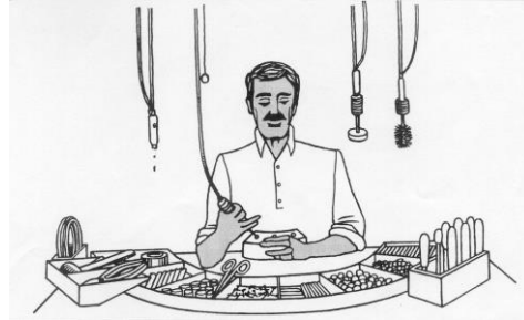
Şekil 6.16. Aletler kolay ulaşılacak yerlere yerleştirilir.
